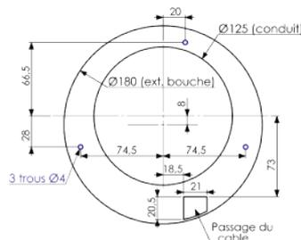
Après avoir retiré la grille, retirer le bornier de connexion. Passer les fils électriques par le passage de câble aménagé sur l'arrière de la platine support.
